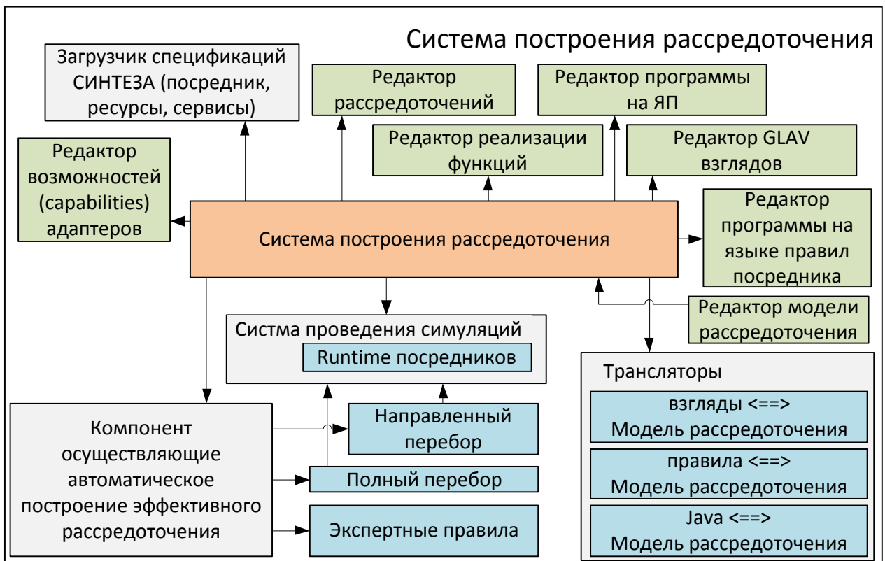
Рисунок 5.1. - Компоненты системы построения рассредоточений
