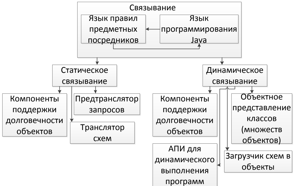
Рисунок 3.1. Структура компонентов связывания языка правил и языка программирования
