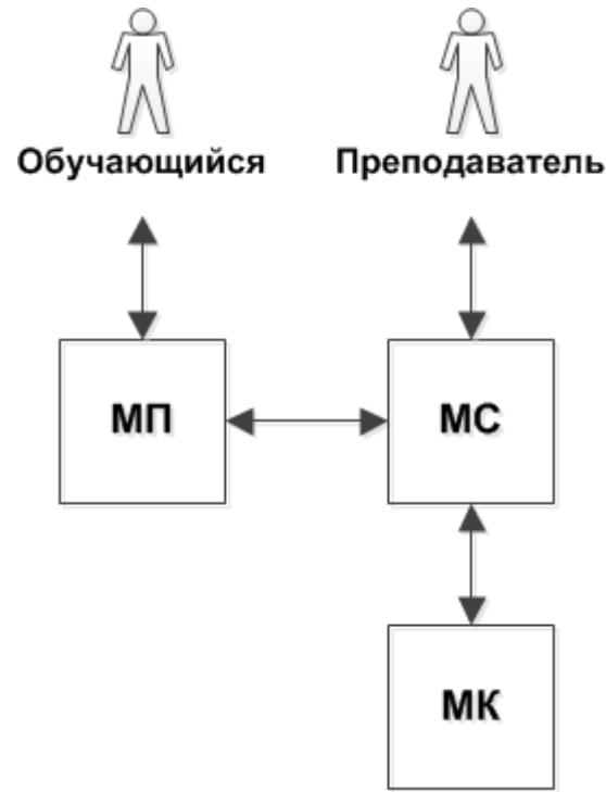
Автоматизированная система виртуального тренажера. В этом случае действия обучающегося по управлению тренажером поступают на МП. МП преобразует сигналы в элементы онтологии, МС на основе продукционных правил может осуществлять логический контроль поступающей информации, поддержку принятия решений и выдачу информации преподавателю. Модуль коммуникации может быть использован в случае группы тренажеров.
