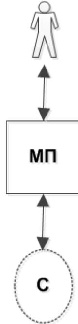
Простейшая система распознавания сигналов, поступающих из среды, с помощью МП. Сигналы могут иметь различную природу. Это может быть система распознавания музыкальной партитуры по звуковому сигналу, система распознавания элементов в видеопотоке и др. Данная система является простейшей, так как в ней отсутствует МС, который должен осуществлять коррекцию логических ошибок. Здесь эта задача возлагается на МП, что может приводить к сложным правилам при распознавании и обработке сигналов.
